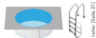
Vollständig im Erdreich versenkt Bei Tiefe 120 und 150 cm
