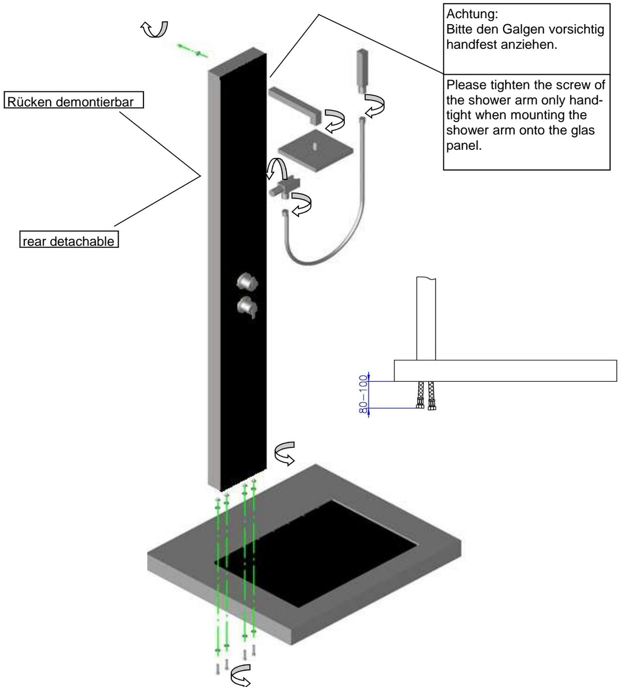
Durch den Transport können sich die Schlauchverschraubungen und Schellen Ihrer Dusche gelöst haben. Sollte die Dusche nach dem Erstanchluss undichte Stellen aufweisen, bitten wir Sie daher, die Rückwand der Dusche abzuschrauben und die Verbindungen nachzuziehen. Vielen Dank.
