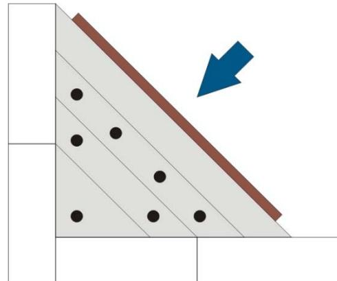
7. Gießen Sie die Stützfüße, sowie den Hohlraum der unteren Stufen mit Beton aus.
