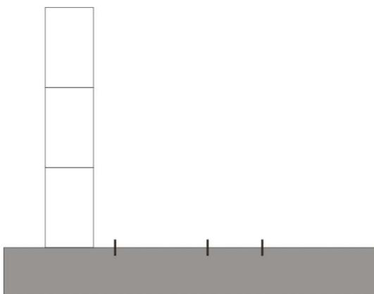
6. Positionieren Sie die Ecktreppe wieder in der Ecke des Pools und befestigen Sie eine Dachlatte am Beckenboden, sodass die Treppe beim Ausgießen nicht verrutschen kann.
