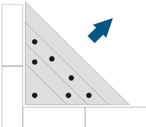
5. Bohren Sie die Montagelöcher für das Armierungseisen und stecken Sie diese in hinein.
