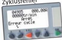
Der Motor wird 5 Minuten unterbrechungsfrei versorgt. Der Vorgang wird unterbrochen und der Motor für 20 Sekunden angehalten. In diesem Zeitraum kann kein Vorgang durchgeführt werden.
