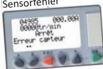
Das Signal des Umdrehungszählers ändert seinen Status nicht. Das System ist blockiert. Das System kann nur mit einer erneuten Initialisierung neu gestartet werden. **Überprüfen Sie den Sensoranschluss.**
